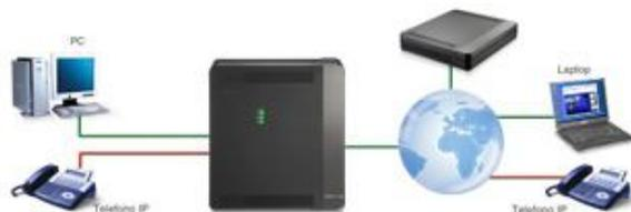
La rete VoIP SPNet può essere strutturata in modi differenti: è possibile infatti collegare più sistemi OfficeServ e terminali multifunzione IP in una rete di architettura complessa.
